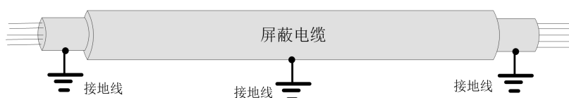
图 3 信号线接地示意图
